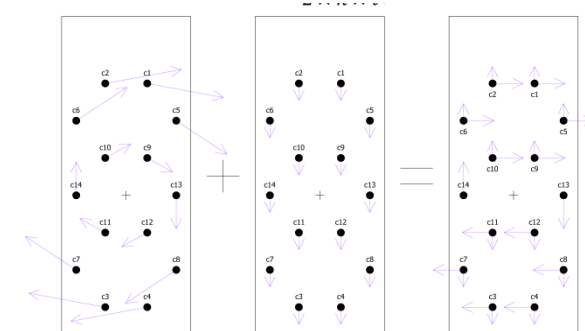
Schema delle azioni sugli spinotti
