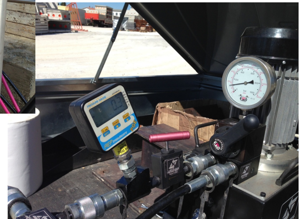
particolare centralina di spinta: manometro meccanico e digitale
