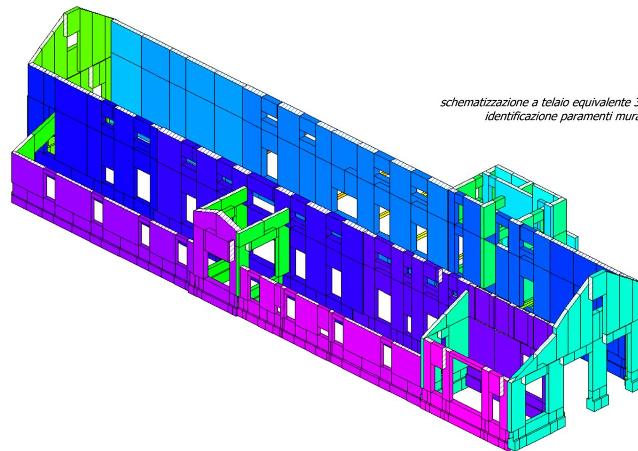
*schematizzazione a telaio equivalente 3D
