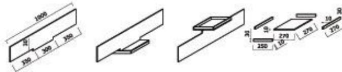
Le lamine pressopiegate che vanno a rinforzare il monaco ed i puntone sono da realizzarsi con uno spessore di 7 mm, attraverso piastre che hanno una larghezza di 500 mm.
